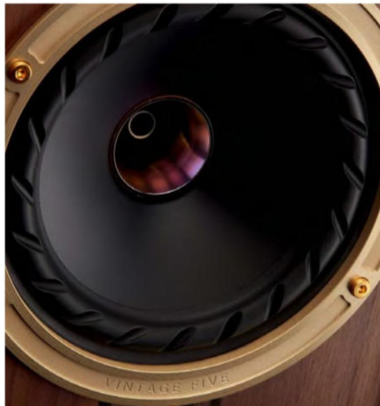
**WOHLPLATZIERT:** Inmitten des 5-Zoll-Tiefmitteltöners aus Multifaser-Papier sitzt ein 19-Millimeter-Druckkammer-Tweeter mit Magnesium-Membran. Für Antrieb sorgt ein Neodym-Magnet.
